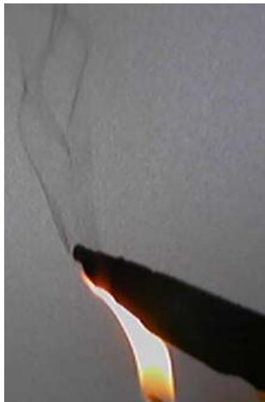
Рис. 2. Горение в пламени образца пенополиуретановой теплоизоляции самозатухающей марки
